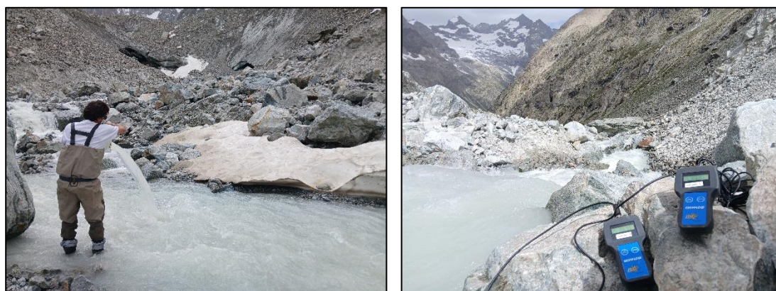
Figure 4 : Injection du traceur et salinomètres installés sur le torrent de Bonne Pierre
