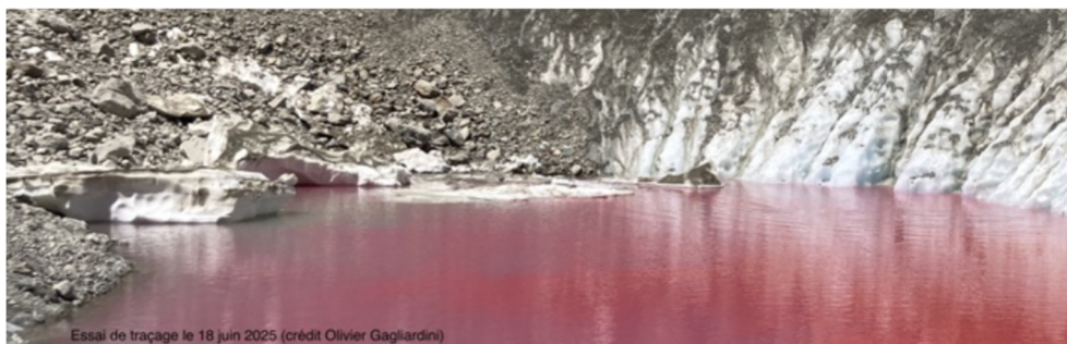
Figure 4: Rhodamine dans la dépression aval du lac avant a vidange complète, le 18 juin 2025. Source : IGE.
