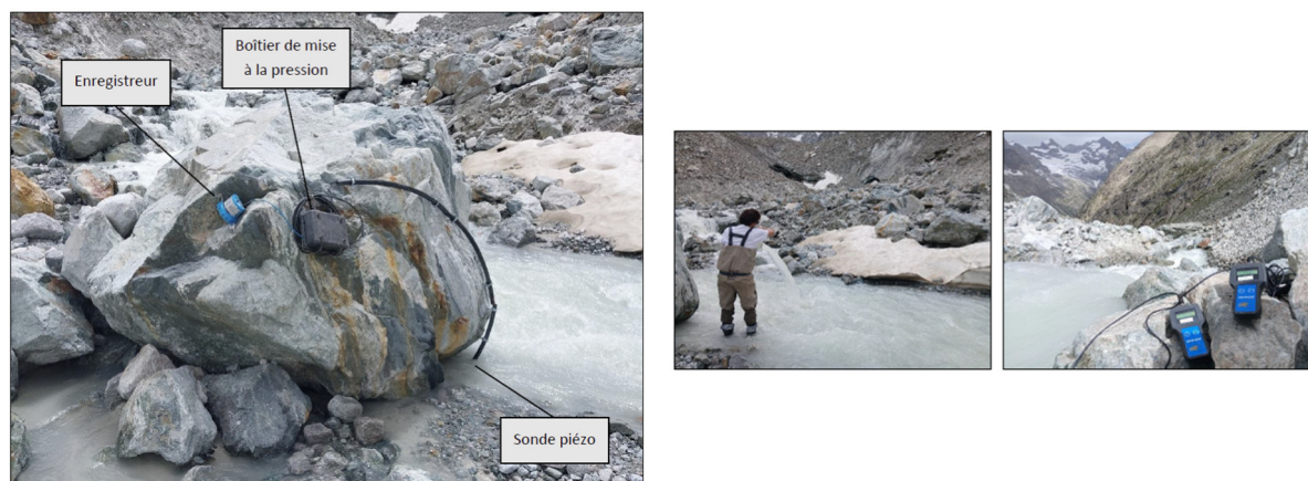
Figure 6: Gauche : capteur de hauteur d'eau. Droite : mesure par dilution au sel (injection et mesure des salinomètres en aval). Source : ATEAU.
